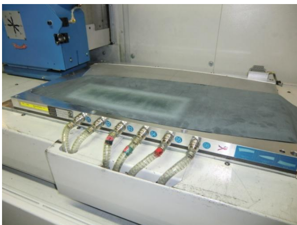
Lederwerkstück während des Schleifvorganges vakuumgespannt
